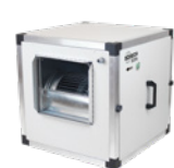
136 CMP/EC Mitteldruck-Radialventilatoren, einseitig saugend, mit Direktantrieb, Turbine mit nach vorn gekrümmten Schaufeln, und EC Technologie-Motor IE5
