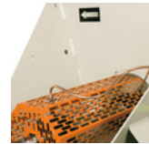
Schmiernippel außen zur Erleichterung der Instandhaltung
