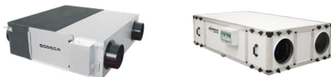
Le récupérateur de chaleur fonctionne en combinant deux ventilateurs centrifuges à faible niveau sonore, dont l'un se charge d'extraire l'air vicié du local et l'autre impulse de l'air frais de l'extérieur vers l'intérieur.
