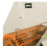
Graisseurs extérieurs pour faciliter l'entretien
