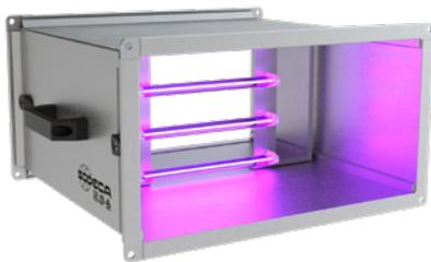
Chambre germicide sans ventilateur pour conduits rectangulaires, équipée de lampes à rayonnement ultraviolet UVc et, en option, d'étapes de filtration. Idéale pour installer dans des systèmes de climatisation et de ventilation existants.
